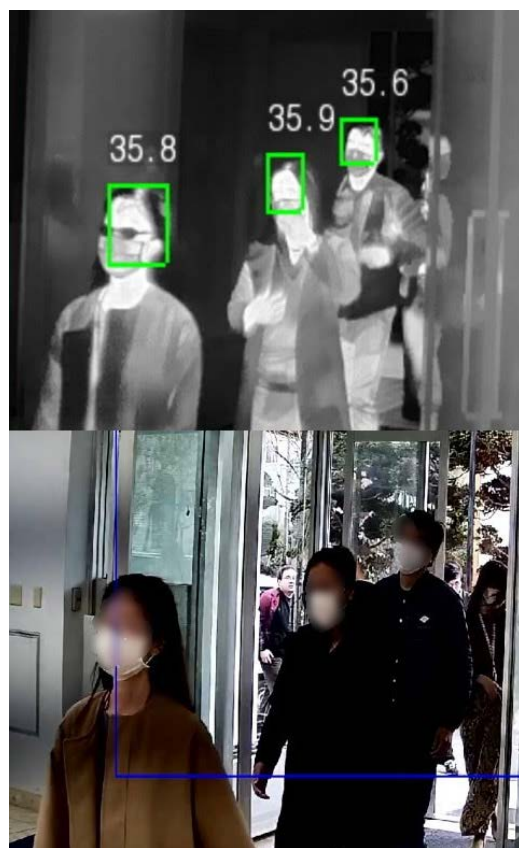
光学カメラと赤外線カメラでスクリーニング
